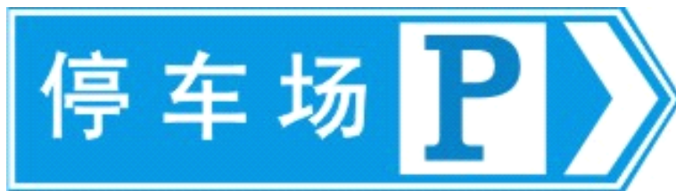
a) 室外停车场预告标志
